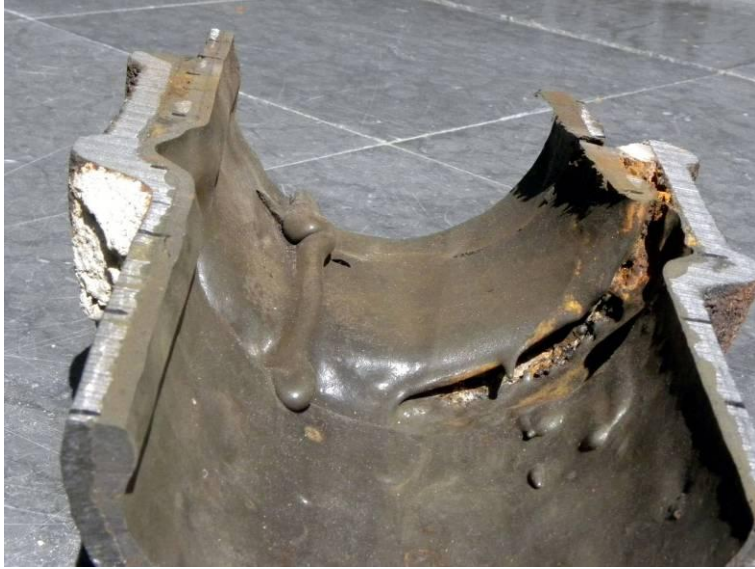
Figur 7. Muffen fotograferad underifrån. Ur detta perspektiv syns spalten som inte täckts av liningen tydligt.
