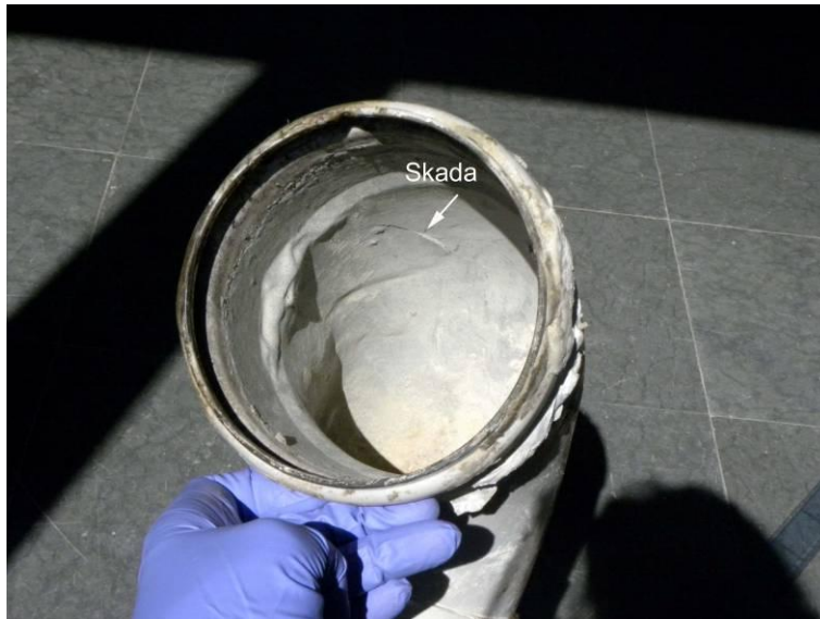
Figur 31. Invändig vy sedd från kröken. Tjockleksvariationerna var små. En skada syntes som dock hade uppkommit på grund av yttre åverkan.
