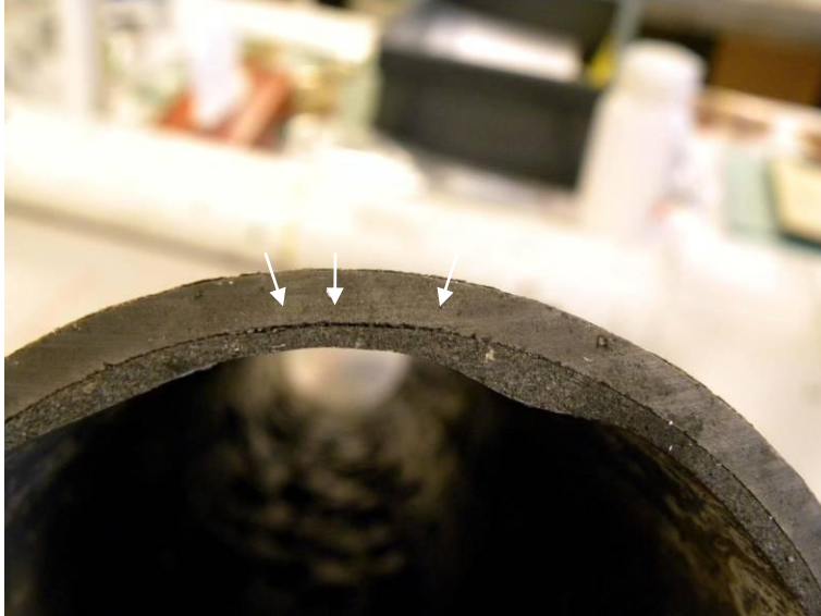
Figur 49. Tvärsnitt som illustrerar förekommande tjockleksvariationer samt viss släppning mellan liner och gjutjärnsröret vid sågningskanten (vita pilar).
