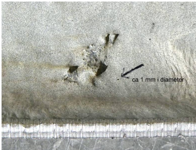
Figur 43. Exempel på en av de mindre håligheterna (diameter cirka 1 mm). Bilden visar även det enda området med oregelbunden yta och materialansamling som fanns i provet.
