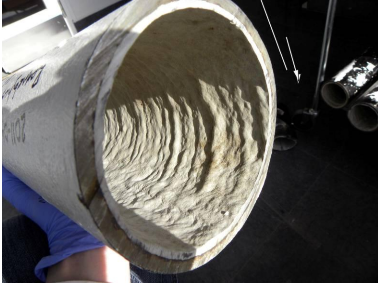
Figur 75. Annan invändig vy som tydliggör tjockleksvariationerna i liningen.
