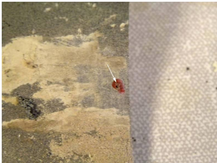
Figur 53. Exempel på en av de få porer som förekom i liningens inneryta. Diametern på håligheten var cirka 1 mm.
