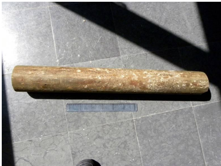
Figur 20. Översiktsbild av det erhållna provet. Provet bestod av ett DN100-rör. Det visade tre stycken yttre skador som antagligen medfört att genomgående sprickor hade bildats.
