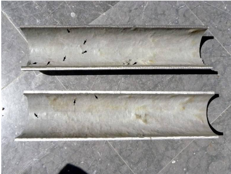
Figur 41. Översiktsbild av det uppsågade röret. De svarta pilarna markerar var porer (cirka 1–2 mm i diameter) i liningens yta upptäcktes.
