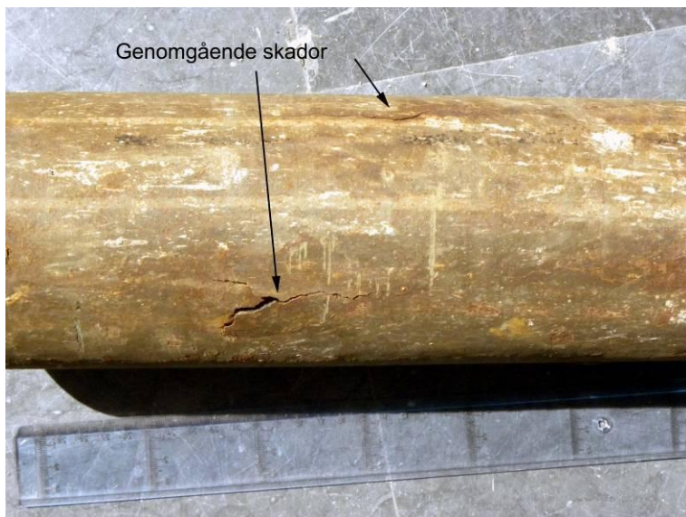
Figur 21. Förstoring som visar två av skadorna i rörprovet.
