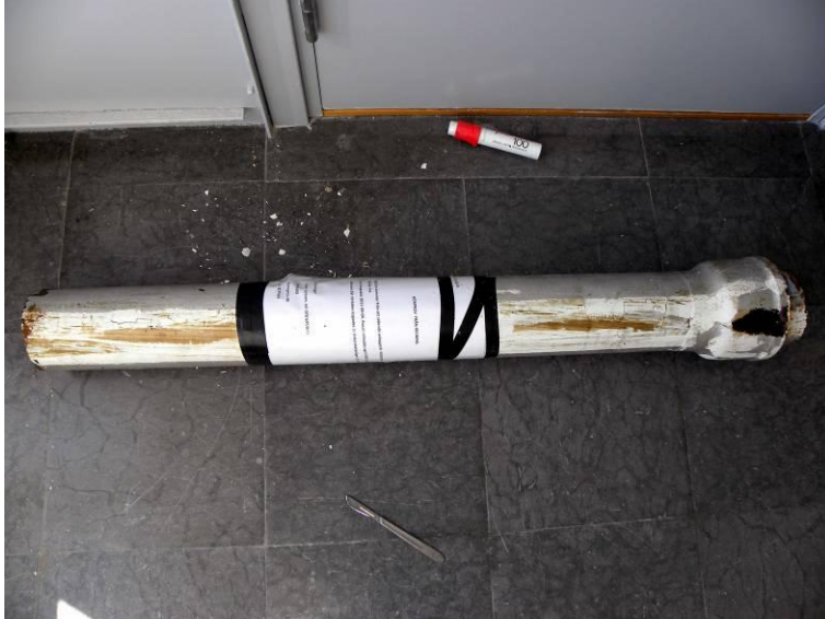
Figur 79. Översiktsbild av det erhållna provet. Provet bestod av ett DN100-rör med muff/koppling och hade en längd av cirka 100 cm.
