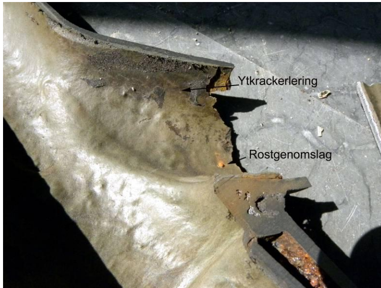
Figur 18. Översiktsbild över den andra halvan av T-stycket. Ytkrackerlering förekom i påsticket. Ett ställe med rostgenomslag har markerats.
