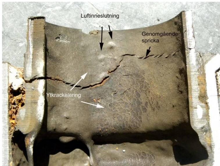
Figur 3. Förstoring av den halvan av muffen/kopplingen som uppvisade kraftigare ytkrackelering. Den genomgående sprickan är markerad. Dessutom visade sig de två markerade blåsorna innehålla luftinneslutningar.
