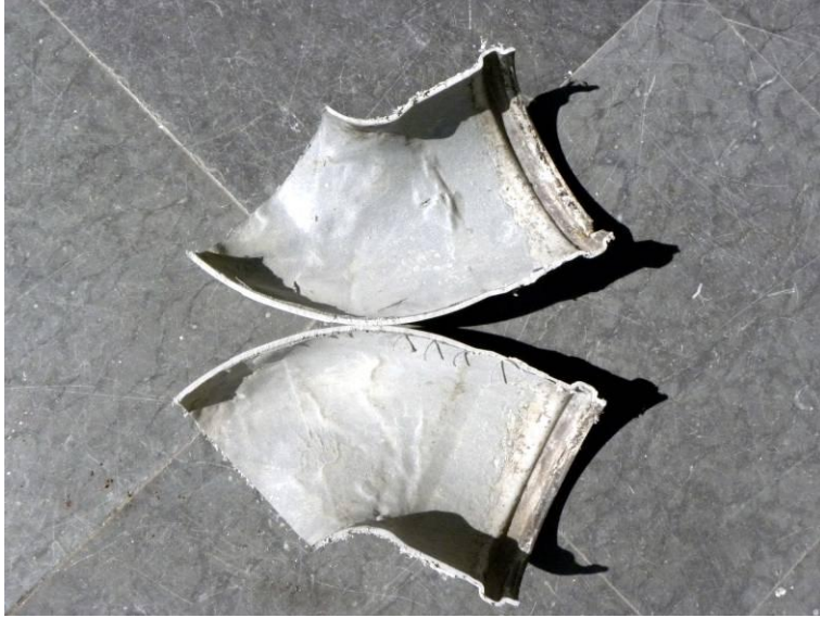
Figur 33. Översiktsbild av den uppsågade rörkröken. Liningen uppvisade ingen missfärgning och ytan var glansig.
