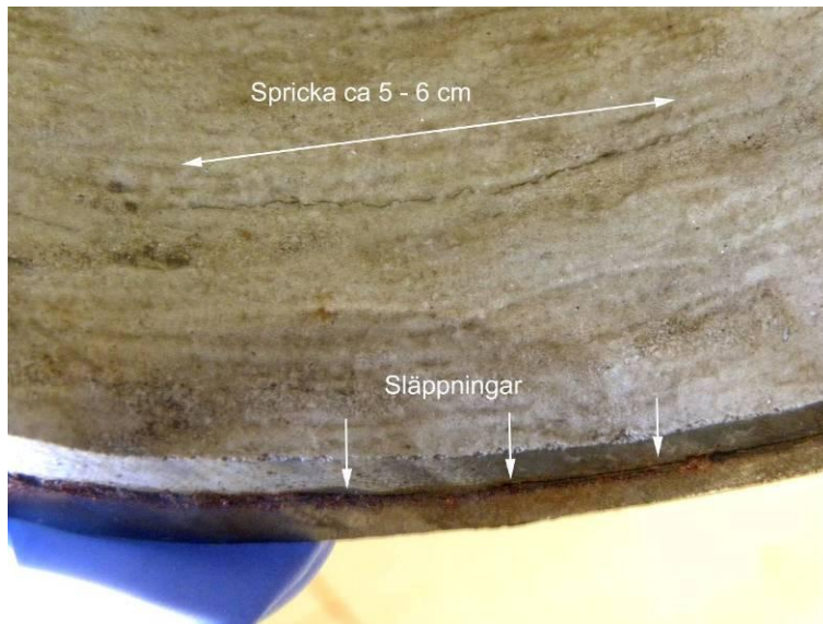
Figur 62. En annan spricka orienterad i omkretsriktning med en längd på cirka 5–6 cm. Den visuella undersökningen medgav ingen bedömning av sprickdjupet. Liningen har släppt från underlaget.
