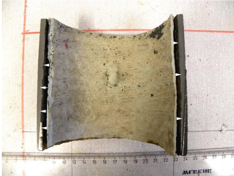
Figur 60. Kraftig släppning mellan infodring och gjutjärnsröret skedde efter sågning då liningens diameter minskade. Detta tydde på inre spänningar i materialet.
