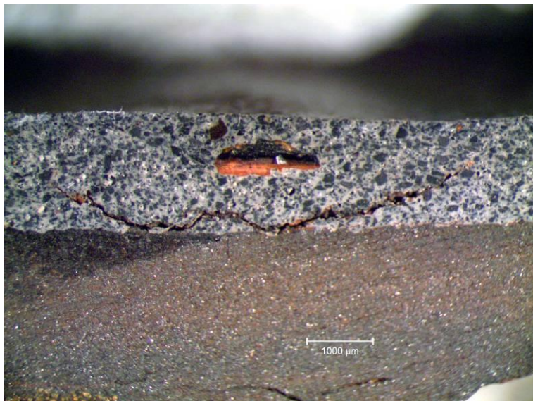
Figur 11. Polerat tvärsnitt som visar en annan delaminering som löpte parallellt med gjutjärnrörets yta. Det förekom även inneslutningar av korrosionsprodukter i liningen.
