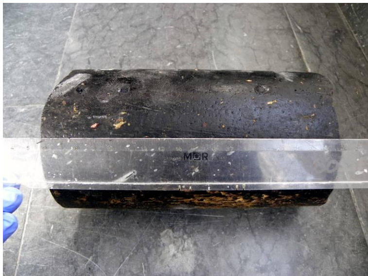
Figur 66. Översiktsbild av det erhållna provet. Provet bestod av ett DN100-rör med en längd av cirka 18 cm.
