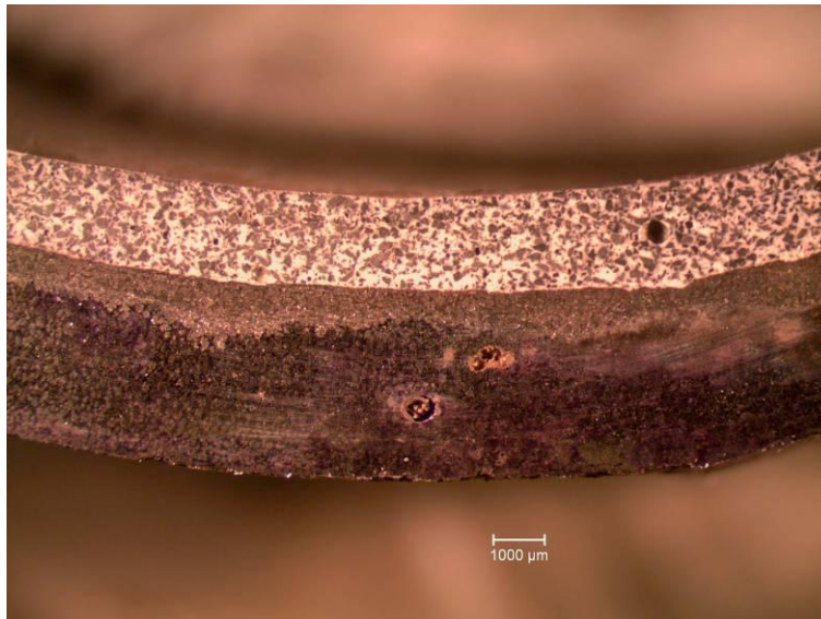
Figur 19. Polerat tvärsnitt som visar liningen och gjutjärnsröret. Provet har tagits från ett ställe utan ytkrackerlering. Gjutjärnsröret uppvisade här grafitering, men inga lösa korrosionsprodukter förekom. Vidhäftningen föreföll vara bra. Gummipartiklarna syntes i epoximatrisen. Liningen innehöll en mindre mängd luftinneslutningar.
