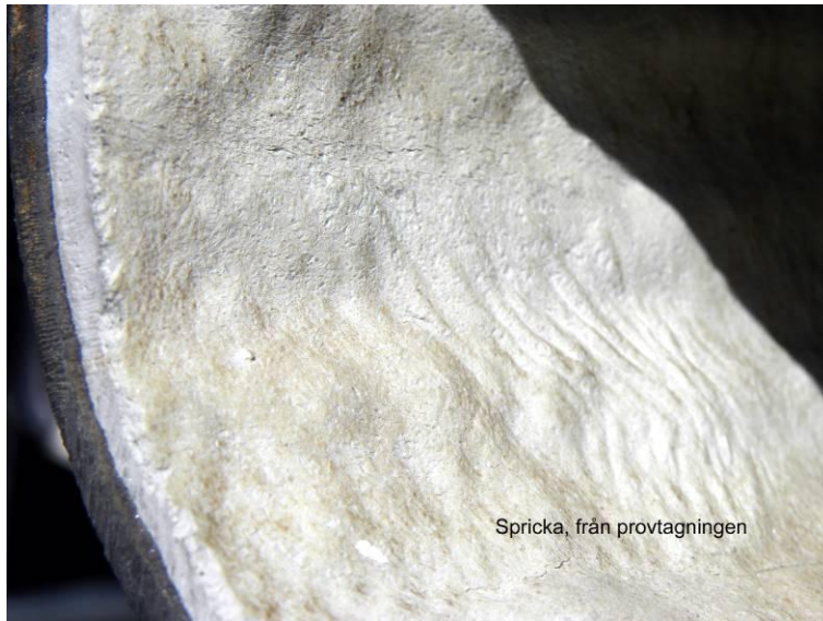
Figur 96. Förstoring av rörets inneryta där viss nötning verkar förekomma. Samtidigt föreföll ytan mycket färsk. Det går därför inte att utesluta att nötningen härstammar från rengörning efter provtagning.
