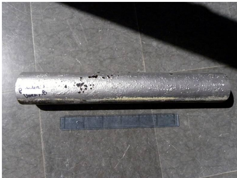
Figur 39. Översiktsbild av det erhållna provet. Röret var målat på utsidan. Inga skador i form av sprickor eller liknande observerades.
