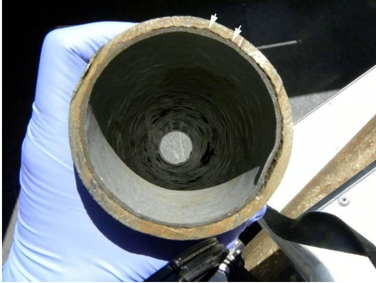
Figur 40. Invändig vy. Ytan och tjockleken föreföll vara någorlunda jämna. Liningen verkade ha bra vidhäftning till underlaget och hade släppt från underlaget på bara några ställen. (Vid den stora släppningen på höger sida drogs liningen loss manuellt.) Grafitering hos gjutjärnsröret förekom endast i mindre uträkning. Inga större mängder lösa korrosionsprodukter fanns.
