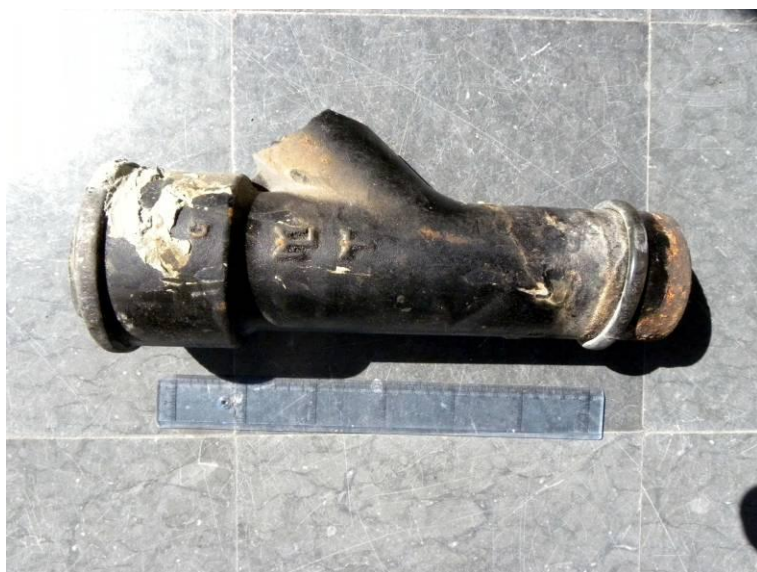
Figur 12. Översiktsbild över det erhållna provet. Provet bestod av ett T-stycke DN 70 med muff/koppling.
