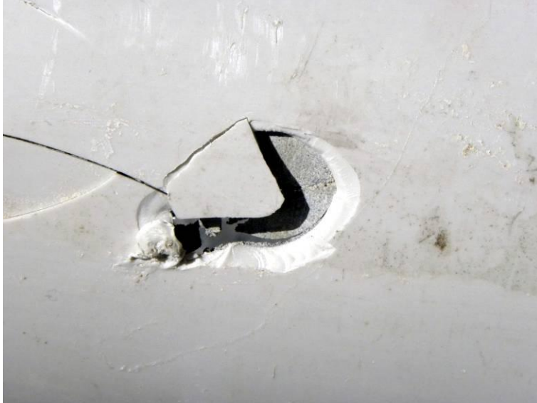
Figur 37. Exempel på yttre skada där plasten har spruckit sprött och tryckt in liningen.
